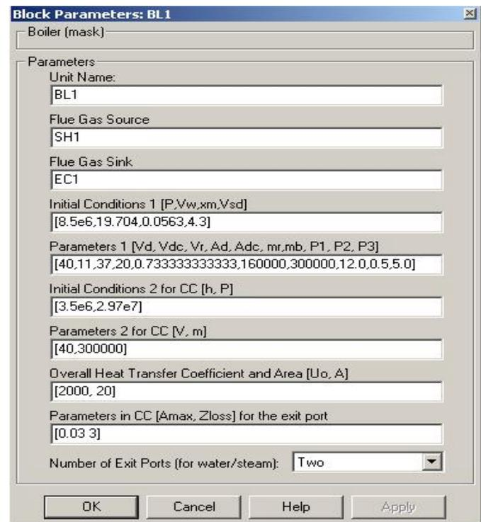
Fig. 2 Drum boiler menu for parameter setting
